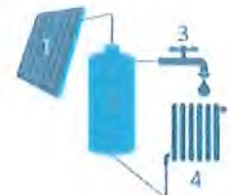
1. Zonnepaneel 2. Zonnecollector 3. Opslagvat 4. Verbruiker
