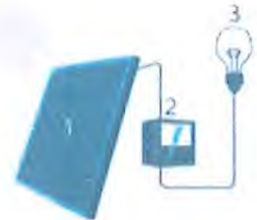
1. Zonnepaneel 2. Omvormer 3. Verbruiker
